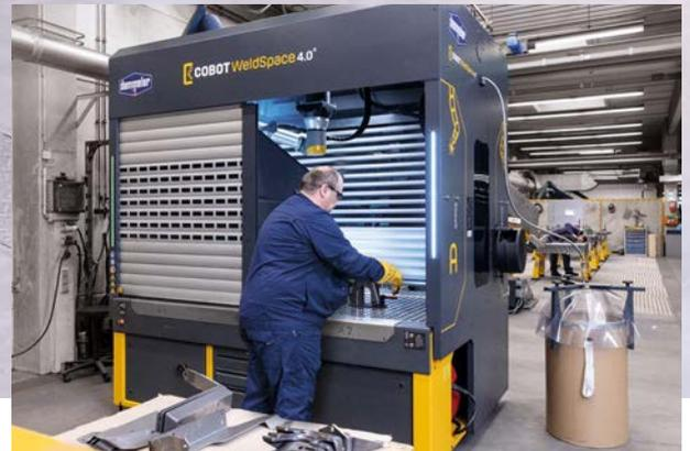
Mit der COBOT WeldSpace 4.0® können mehrere, teilweise unterschiedliche Teile gleichzeitig geschweißt werden. Das automatische Verfahren der Umhausung ermöglicht das Arbeiten im Mehrstationenbetrieb. Während der Roboter auf der einen Seite schweißt, kann der Bediener geschützt durch herunterfahrbare Rolltore mit Aluminiumpanzer und integriertem Schweißerschutzglas auf der anderen Seite zeitparallel Rüsten und Umspannen (Zwei-Stationen-Betrieb).
