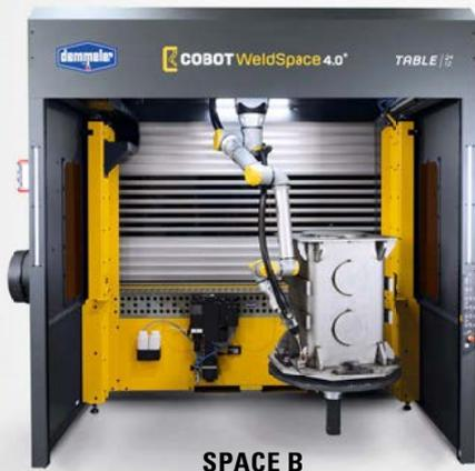
Je nach Anforderung kann der Arbeitsbereich **SPACE B** optional mit einem weiteren **DEMMELE**R 3D Schweißstisch in einer maximalen Größe von 2.000 x 1.000 mm oder mit einem Zwei-Achsen-Manipulator mit bis zu 500 kg Nutzlast ausgestattet werden. Dieser ermöglicht ein hochproduktives Schweißen in Wannelage.
