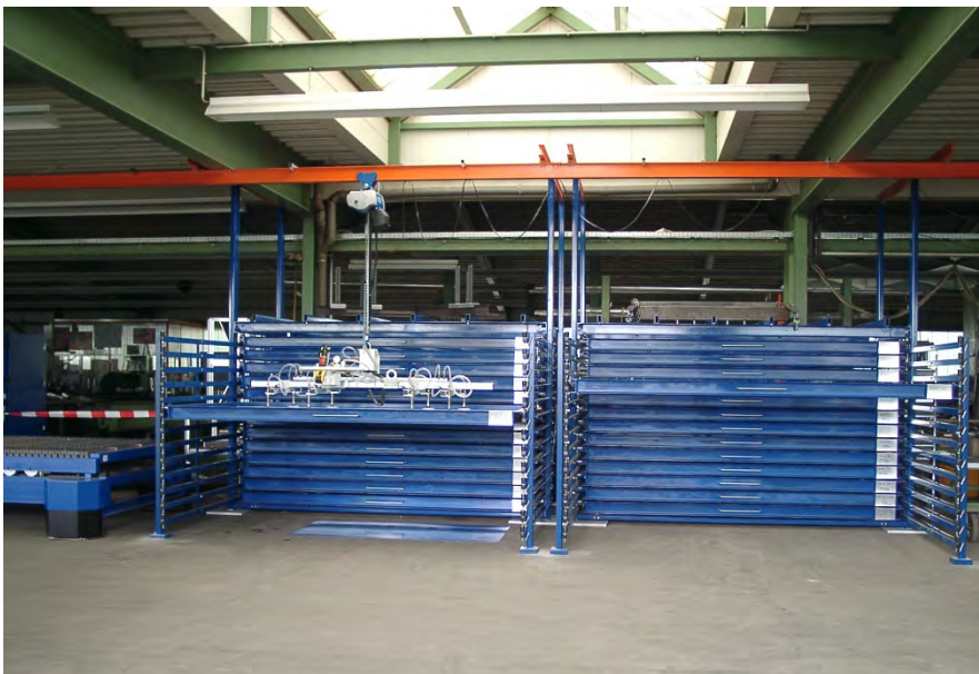
Doppelanlage zur Beladung mit einem festen Hallenkran.
