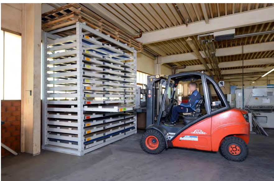
Blechauszugregal zur Beladung mit dem Stapler.
