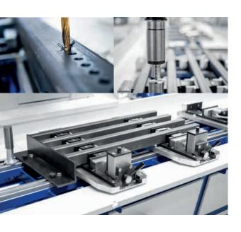
Durch die Automatisierung des Bohrprozesses mit der **KBA40** werden signifikant kürzere Bearbeitungszeiten erreicht. Das System ermöglicht ein kontinuierliches Arbeiten ohne die Notwendigkeit, die Maschine zwischen den Bohrungen zu justieren.
